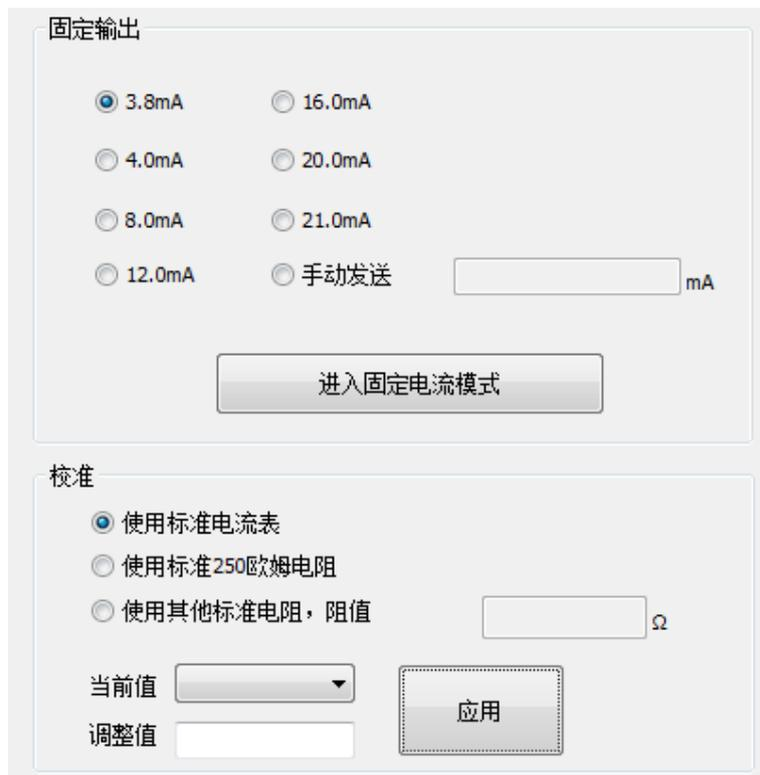
图 5.7 校准电流选项卡
